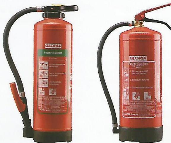
Bei den qualitativ hochwertigen Feuerlöschern, den **Aufladefeuerlöschern**, wird das Gas in einer besonders dickwandigen Treibmittelflasche bis zur Inbetriebnahme gespeichert. Die abzudichtende Fläche ist nur sehr klein, womit ein Nichtfunktionieren durch Undichtigkeit bei dieser Feuerlöscher-Bauart so gut wie ausgeschlossen werden kann.
