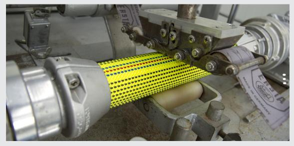
Für die Anwendung von besonderem Interesse ist die mechanische Beständigkeit des Schlauches gegen Abrieb. In den Normen kommen verschiedenste Prüfapparaturen, zumeist mittels Schleifpapier, zur Anwendung. Nach einer definierten Anzahl von Scheuerrotationen hat der Schlauch der Belastung durch den Arbeitsdruck standzuhalten.
