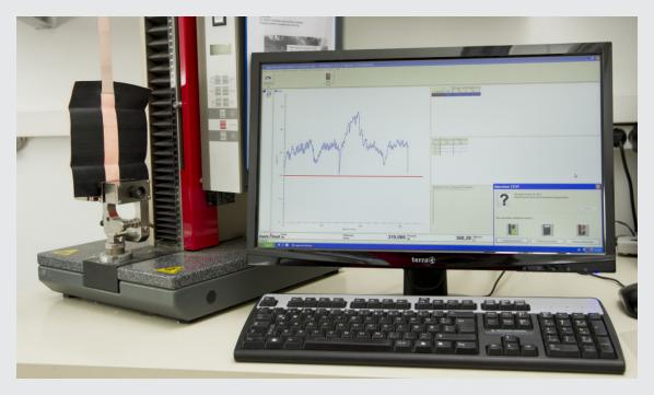
Ein wesentliches Qualitätskriterium ist die Haftung zwischen Gewebe und Innenauskleidung. Dieser Haftwert ist zumeist auch entscheidend über die Langlebigkeit eines Schlauches. Geringe Haftwerte führen zum Ablösen der Dichtschicht in Anwendung und Lagerung und somit zum frühzeitigen Versagen der Schlauchkonstruktion.
