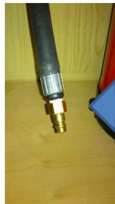
Herstellen vom Betriebsdruck über den Schlauchadapter
